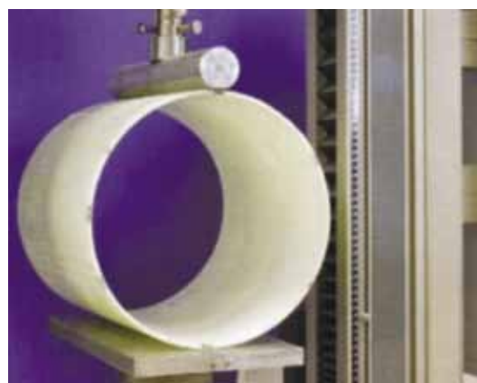
Измерение модуля эластичности полимерного рукава
